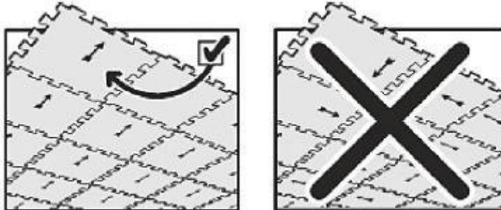
Neben der Verlegung im Kreuzfugenverband ist bei diesen Fliesen auch die Möglichkeit gegeben diese im Halbversatz zu verlegen.
